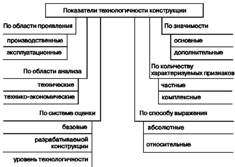
Рис. 3.3. Классификация показателей технологичности конструкции изделий
